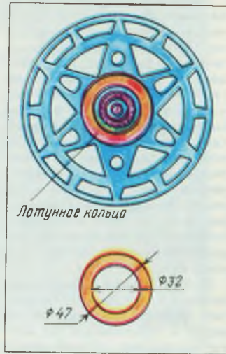
Внутренний диск барабана с вставленным латунным кольцом.
